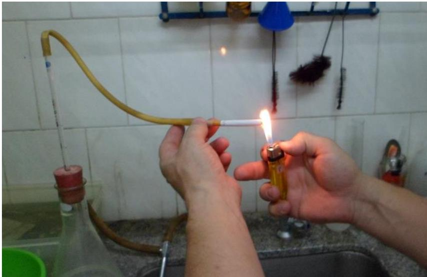
**Fig.3.15.- Combustión de cigarrillo de tabaco; succión realizada mediante bomba de vacío (izq).**
