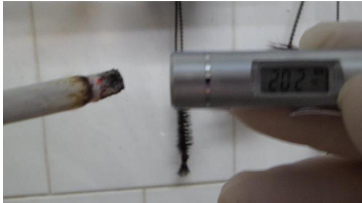
**Fig. 3.17.-** Medición de temperatura de combustión de cigarrillo de tabaco, el lector marca **202 °C.**
